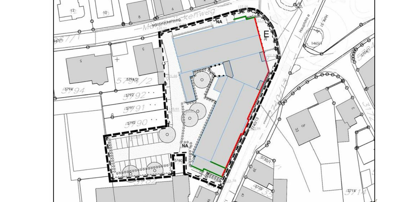
Abb.1: Lageplan mit Kennzeichnung der Fassaden, an denen Schallschutzmaßnahmen erforderlich sind
